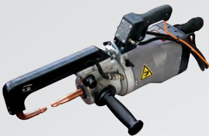
Il trasformatore interamente progettato e costruito da **TECNA**, è integrato nella pinza e raffreddato ad acqua in modo tale da massimizzare la produttività e **aumentare il "duty cycle"**.
