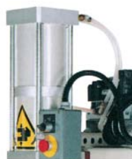
Арт. 8235 Цилиндр 1242 даН (двойн. ход Ø125 мм), общий ход 100 мм, двойной ход 60+40 мм (только для машин 8201-2-3-4-5-6-7-8-9-14).
